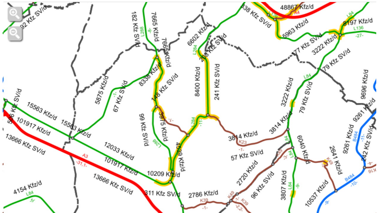
Abb. aus https://www.nwsib-online.nrw.de : Daten der HR aus 2019 – Ortsdurchfahrten gelb hinterlegt - erkennbar: 8400 Kfz/Tag zw. Hofferhofer Str. und Leimbach (> 3 Mill./Jahr)
